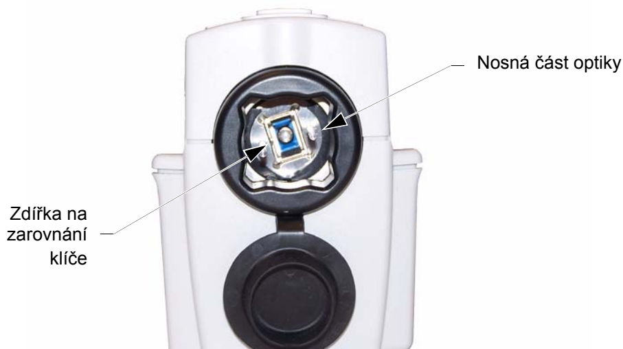
Obrázek 9-4: Zarovnání optického adaptéru s nosnou částí optiky
