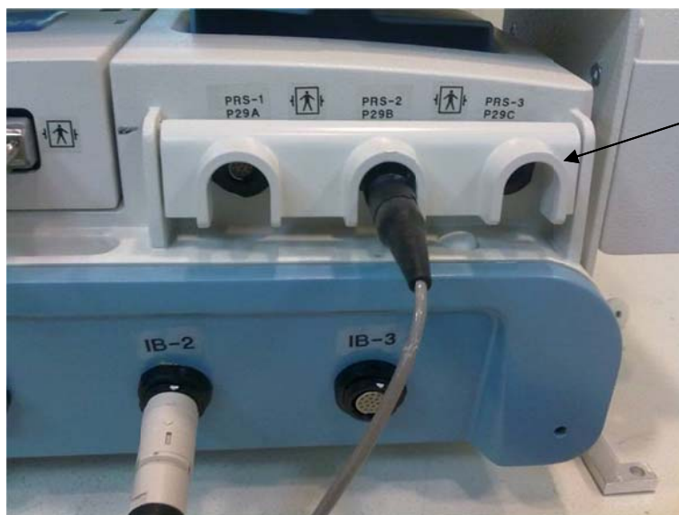
Obrázek 4-9: Připojení referenčního senzoru pacienta MediGuide k jednotce MediGuide Connect
